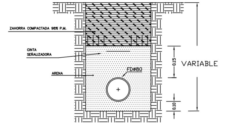
ZANJA TIPO AGUA POTABLE REPOSICIÓN HORMIGÓN
