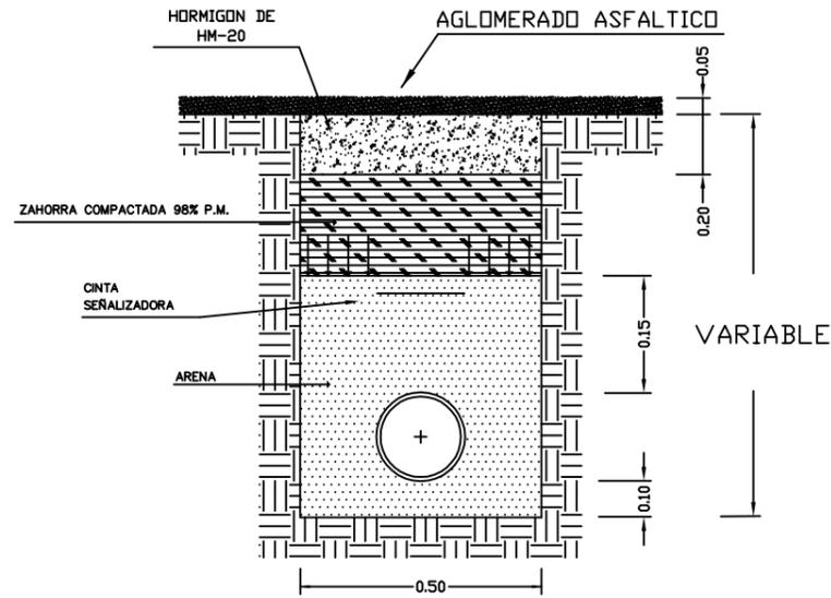
ZANJA TIPO AGUA POTABLE CON REPOSICION
