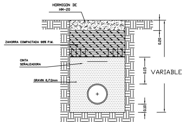
ZANJA TIPO SANEAM./PLUVIALES REPOSICIÓN HORMIGÓN
