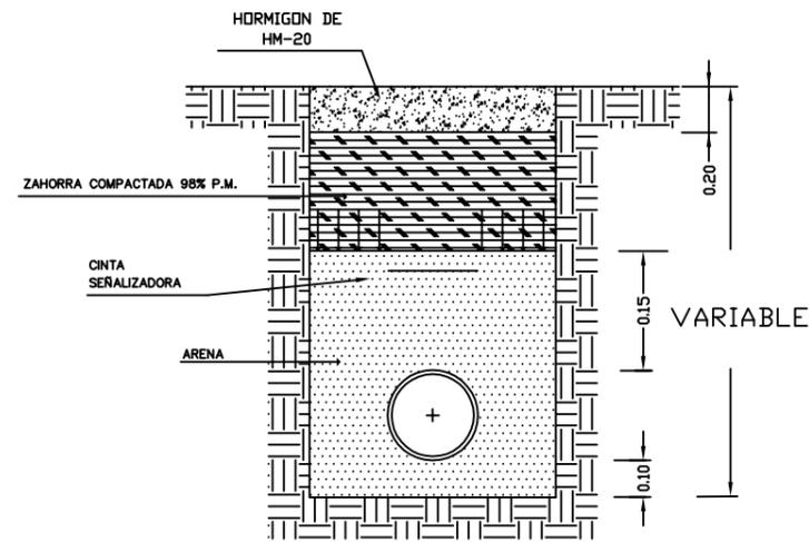
ZANJA TIPO AGUA POTABLE REPOSICIÓN HORMIGÓN
