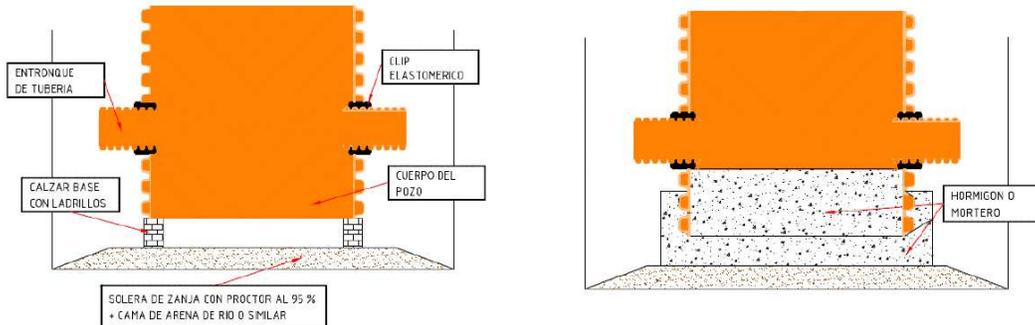
2.- Si el pozo se instala con su base plástica, se prepara también una solera de hormigón de limpieza, aunque ahora sólo a efectos de fijar el fondo del pozo ya que la estanqueidad queda garantizada por la base plástica que incorpora una junta de estanqueidad. En este caso el pozo debe hormigonarse siempre por dentro hasta la generatriz inferior del colector, para lastrar el pozo frente a empujes verticales del nivel freático.
