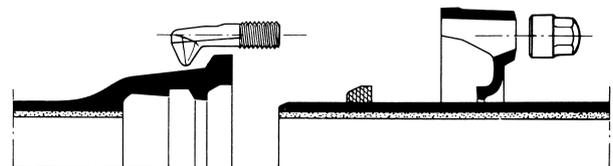
Unión por junta mecánica
