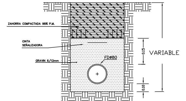
ZANJA TIPO SANEAM./PLUVIALES SIN REPOSICIÓN
