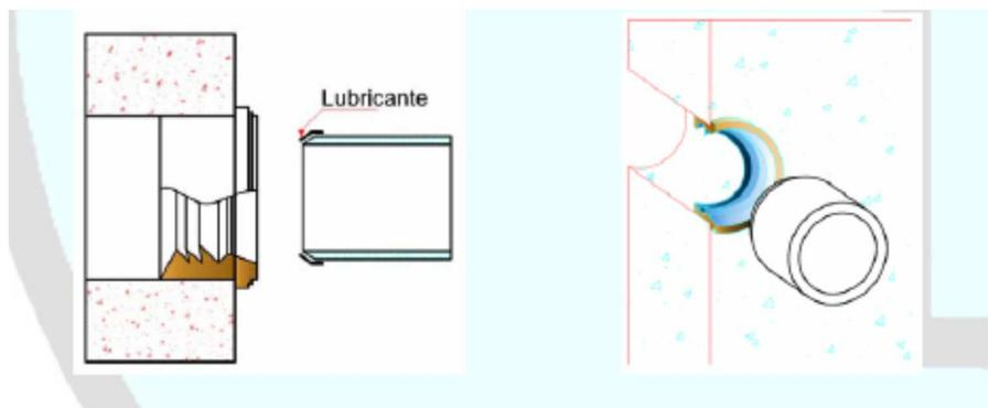
Alinear longitudinalmente los tubos cortos (máx 1,50m) que permiten la absorción de los asientos diferenciales de los pozos con los tubos que se van a enchufar, comprobando que la junta hace contacto con la zona exterior del tubo de hormigón a lo largo de toda su circunferencia y proceder a su enchufe.
