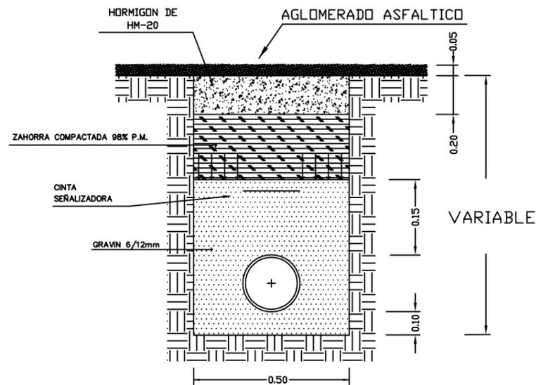
ZANJA TIPO SANEAM./PLUVIALES CON REPOSICIÓN
